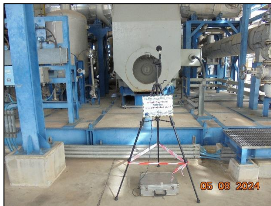
รูปที่ 4.18 การตรวจวัดระดับเสียงเฉลี่ยตลอดระยะเวลาการทำงาน บริเวณ Compressor Area : C-320
