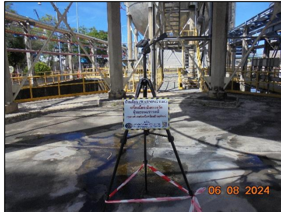
รูปที่ 4.29 การตรวจวัดปริมาณเอทิลีนออกไซด์ บริเวณ EO Storage Tank (D-1410A)
