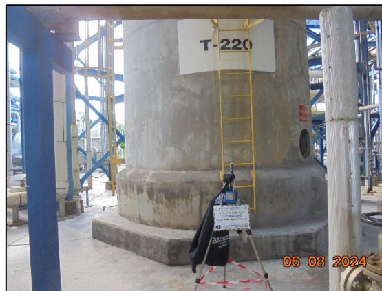
รูปที่ 4.24 การตรวจวัดปริมาณคาร์บอนไดออกไซด์ บริเวณ CO 2 Removal (T-220)
