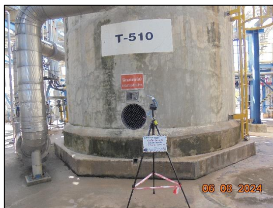
รูปที่ 4.25 การตรวจวัดปริมาณฟอร์มัลดีไฮด์ บริเวณ Glycol Feed Stripper (T-510)
